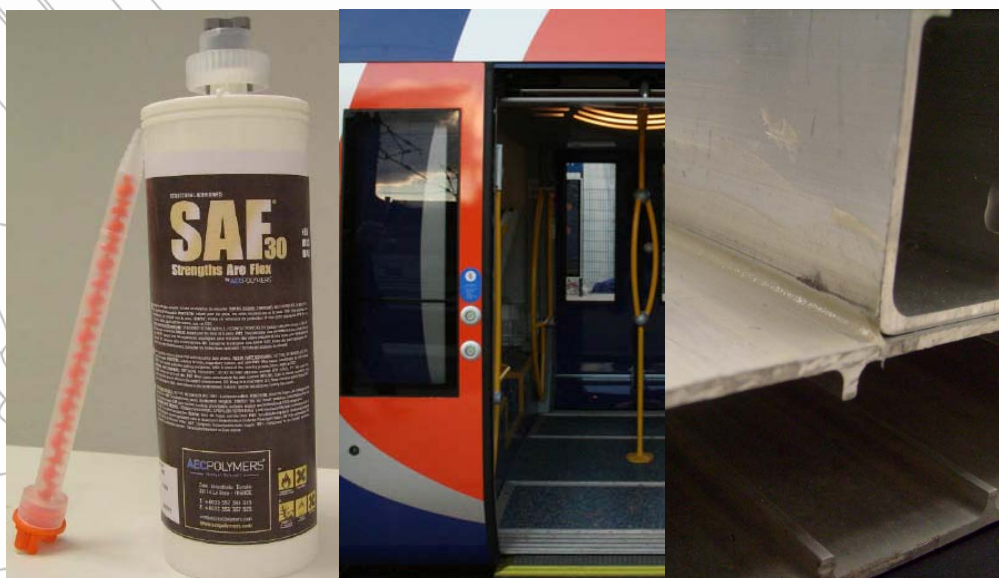
Ohišje vlaka – lepljenje aluminij + aluminij
