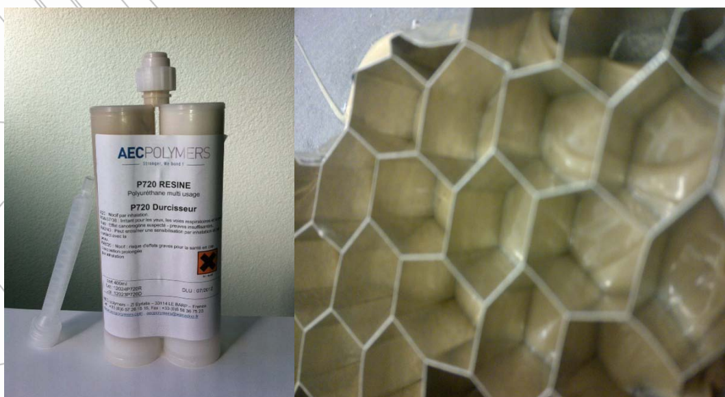
Lepljenje aluminijastega satovja na nerjavečo pločevino
