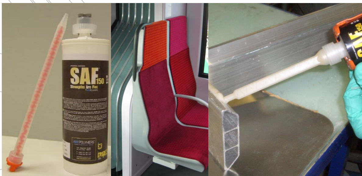
Strukturna vgradnja sedežev – lepljenje aluminij + aluminij
